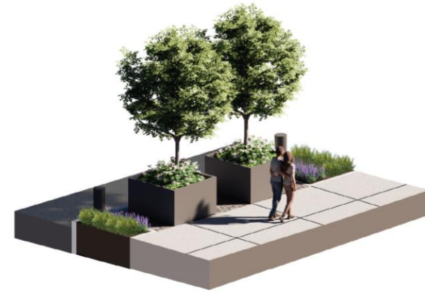
Macetas con clasificación de choque (M50)
