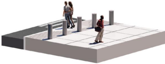
Bolardos con clasificación de choque (M50)
